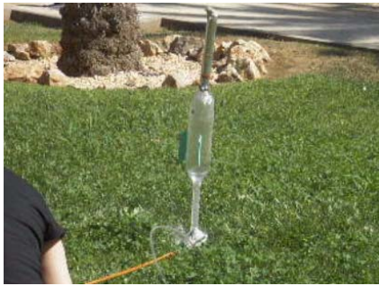
Figura 1. En el lanzamiento se expulsa el chorro de fluido rápidamente, y el cohete se impulsa hacia arriba.
